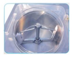
La caldera de calentamiento esta fabricada en material transparente para que el operador pueda observar y agregar fácilmente los ingredientes.
