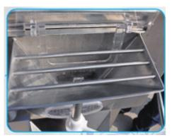
Entrada amplia y antisalpicaduras conveniente para el ingreso y observación de la mezcla, las piezas adoptadas logran un correcto funcionamiento y protegen a los operadores.
