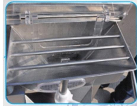
Entrada amplia y antisalpicaduras conveniente para el ingreso y observación de la mezcla, las piezas adoptadas logran un correcto funcionamiento y protegen a los operadores.
