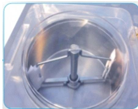
La caldera de calentamiento esta fabricada en material transparente para que el operador pueda observar y agregar fácilmente los ingredientes.
