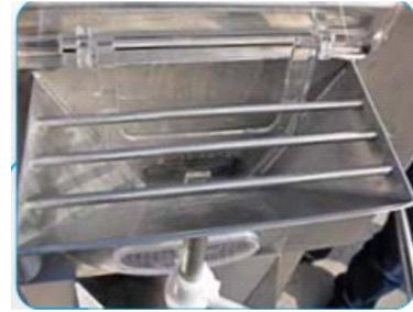
Entrada amplia y antisalpicaduras conveniente para el ingreso y observación de la mezcla, las piezas adoptadas logran un correcto funcionamiento y protegen a los operadores.
